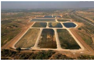
Bassin d'infiltration en Israël
